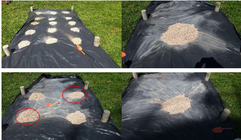
Figura 1. Passo a passo do método do quartejamento
